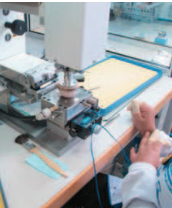
Décalque sur machine semi-automatique / Transfer on semi-automatic machine
