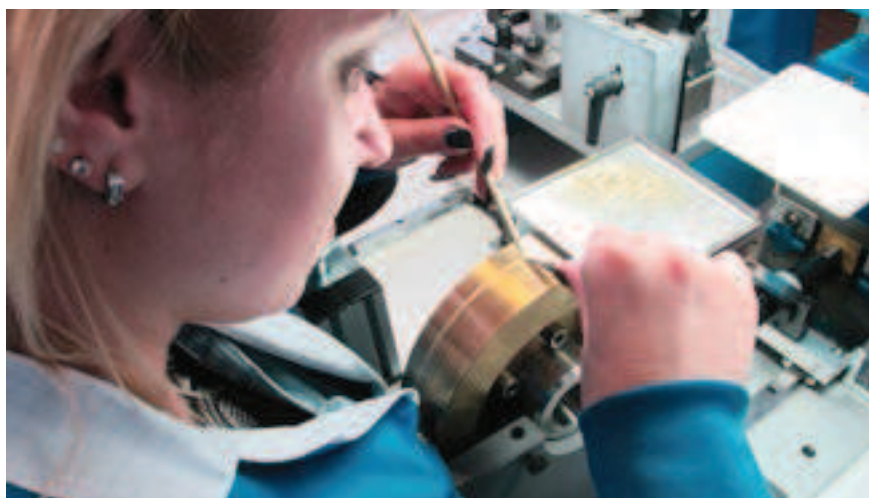
Posage des appliques sur tambour / Fitting of appliques on a drum
