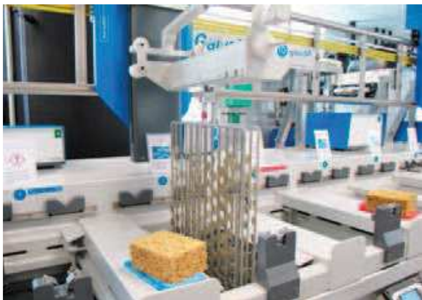
Robot for galvanic colouring process / Automate de mise en couleur galvanique
