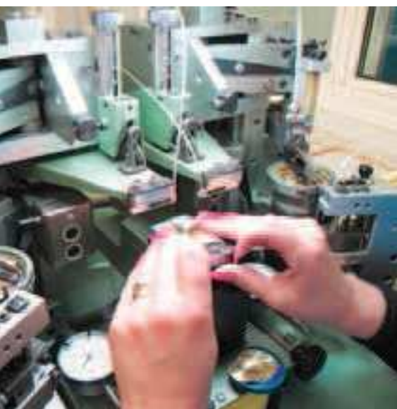
Feet soldering operation / Opération de soudage des pieds
